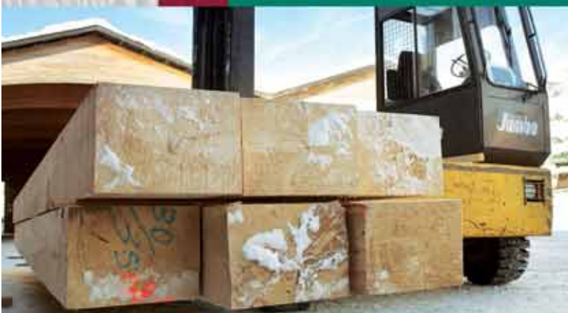
Konstruktionshölzer bis 45 x 45 cm und 15 m Länge
